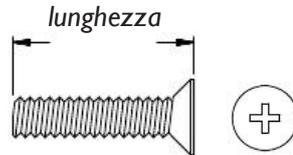
**NOTA:** per identificare viti e bulloni in base alle misure indicate occorre considerare la lunghezza dal margine inferiore della testa (ad esclusione delle viti svasate).
